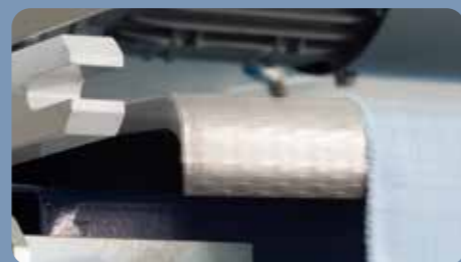
Stoffspeicher für spannungsfreies Legen
