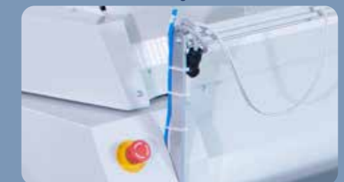
Fotozelle zur Kantensteuerung
