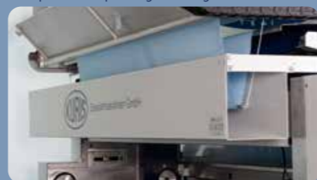
Stoffspeicher für spannungsfreies Legen
