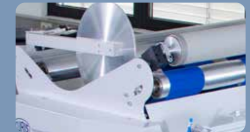
Gegenlaufwalze und Ausstreifwalze
