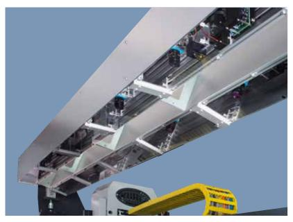
Das Bildverarbeitungssystem visitexLOC wurde speziell für den Einsatz auf Textil- und Teppichschneidemaschinen der Firma KURIS entwickelt und dient zur automatischen Ermittlung von Schnittkoordina-
