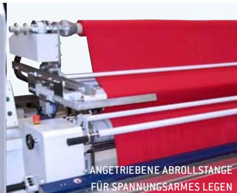
ANGETRIEBENE ABROLLSTANGE FÜR SPANNUNGSARMES LEGEN
