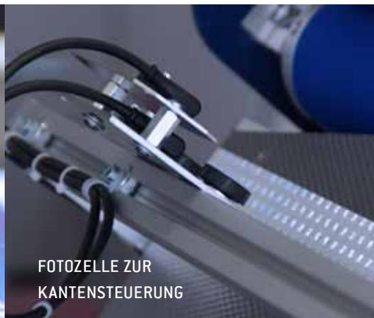
FOTOZELLE ZUR KANTENSTEUERUNG
