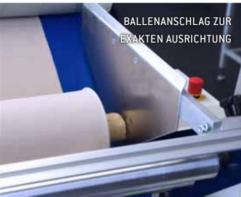
BALLENANSCHLAG ZUR EXAKTEN AUSRICHTUNG
