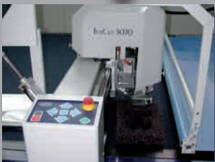
Hochlagen-Cutter 3070 bei der Bearbeitung von 70mm Schaumstoff.
