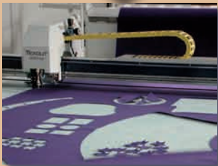
TexCut 3001 bei der Bearbeitung von technischem Gewebe in der Einzellage.
