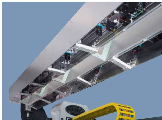
Das Bildverarbeitungssystem visitexLOC wurde speziell für den Einsatz auf Textil- und Teppichschneidemaschinen der Firma KURIS entwickelt und dient zur automatischen Ermittlung von Schnittkoordinaten.
