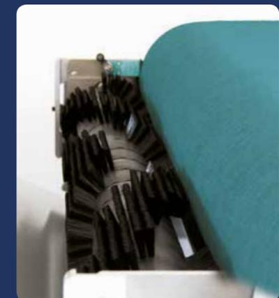
Reinigungsbürste: Die optional erhältliche Reinigungseinheit eliminiert Schneidrückstände.
