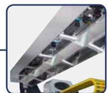
**mit dem integrierten Kamera-System** werden die Textilien / Teppiche aufgenommen. Die Kameras erlauben eine rasche Aufnahme und unmittelbare Wiedergabe des gescannten Bildes. Die intuitive Bedienoberfläche „visitexLOC“ ermöglicht die Handhabung des Systems in kürzester Zeit. Einfache Kommunikation zwischen Software und Cutter.
