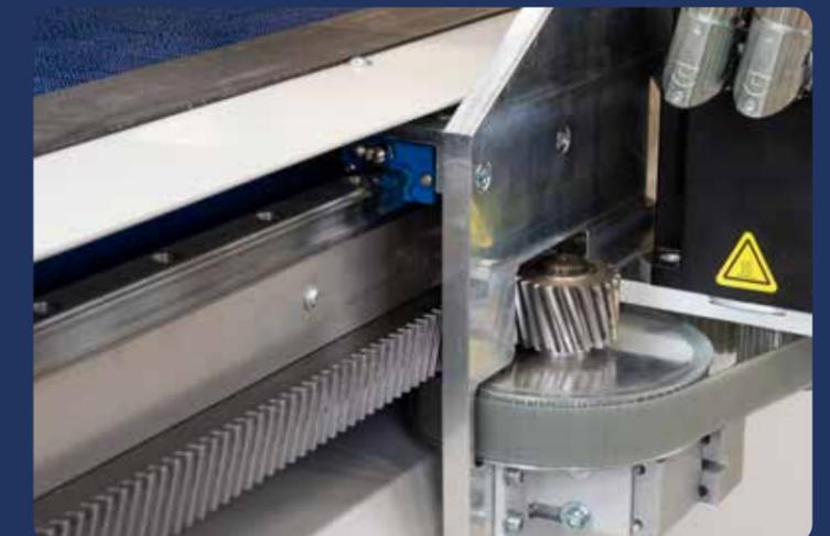
Zahnradantrieb für einen wartungsfreien und exakten Lauf der Brücke inkl. Schneidkopf
