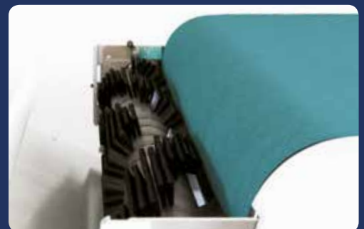
Reinigungsbürste: Die optional erhältliche Reinigungseinheit eliminiert Schneidrückstände.
